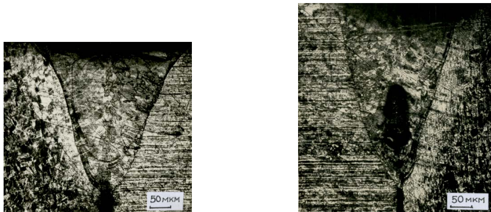
Рис.6. Микроструктура зоны проплавления трещиноподобного дефекта при постоянной длительности импульса излучения ОКГ \tau=1,5 мс. Напряжение на модуляторе U_M, В : 1) 600; 2) 800
