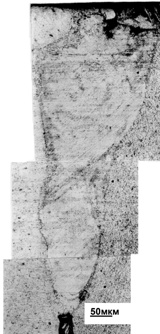
Рис.8. Микроструктура зоны проплавления трещиноподобного дефекта: \tau=4,0 мс; U_m=400 В; \lambda_{\text{изл}}=1,06 мкм; сталь 08X18N10T. \times 200 ; фокусировка излучения на глубину h\sim 0,7 мм
