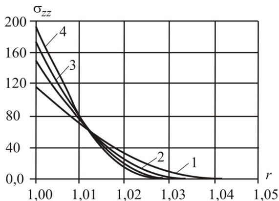
Рис. 5. Распределение нормального напряжения по толщине пленки в зависимости от числа  $We$ : 1) 50; 2) 100; 3) 150; 4) 200
