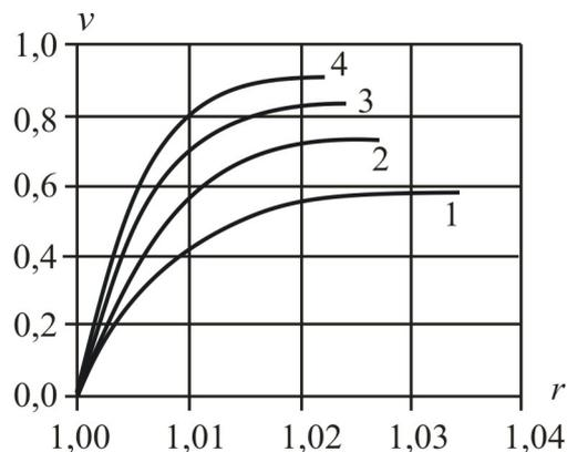
Рис. 4. Распределение скорости по толщине пленки в зависимости от  $We$ : 1) 50; 2) 100; 3) 150; 4) 200
