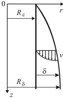
**Рис. 1.** Геометрическая схема течения пленки:  $r, z$  – цилиндрические координаты;  $R_c$  – радиус цилиндра;  $\delta$  – толщина стекающего слоя жидкости;  $R_\delta = R_c + \delta$  – расстояние до свободной поверхности
