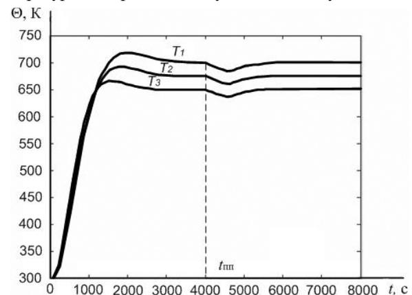
Рис. 6. Переходные процессы изменения температуры греющей камеры БВП:  $T_1$ ,  $T_2$ ,  $T_3$  – постоянные времени в греющих камерах 1, 2, 3;  $t_{инн}$  – время переходного процесса
