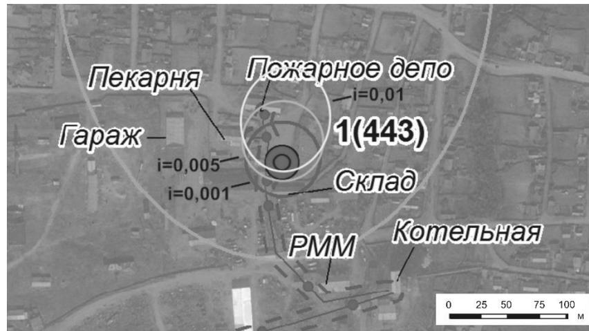
Рисунок 1 – Схема расположения хозяйственных объектов и поясов ЗСО 2-го порядка при разных значениях уклона фильтрационного потока
