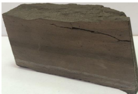
Рисунок 1 – Образец керна баженовской свиты. Глубина отбора 2822,7 м
