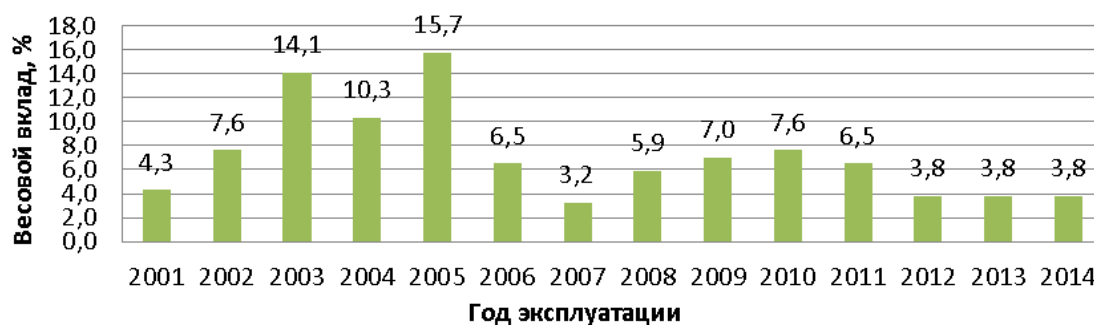
Рисунок 2 – Динамика аварийных остановок ЭГПА в зависимости от временных периодов эксплуатации
