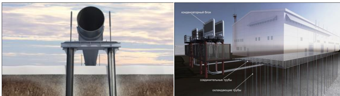
Рисунок 1 – Термостабилизаторы в свайном фундаменте
