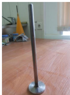
Рисунок 2 – Элемент передачи механической нагрузки на образец
