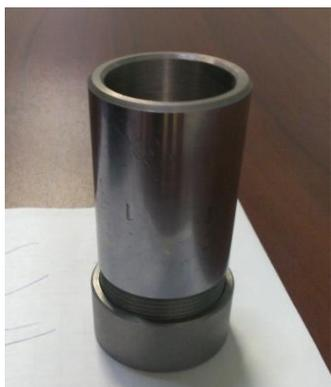
Рисунок 1 – Металлический стакан-зажим образцов резины эластомера
