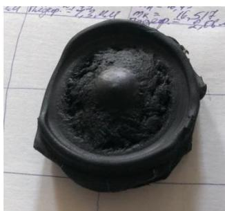
Рисунок 3 – Образец ИРП-1226 после эксперимента с массой груза 6 кг
