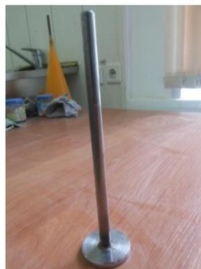
Рисунок 2 – Элемент передачи механической нагрузки на образец
