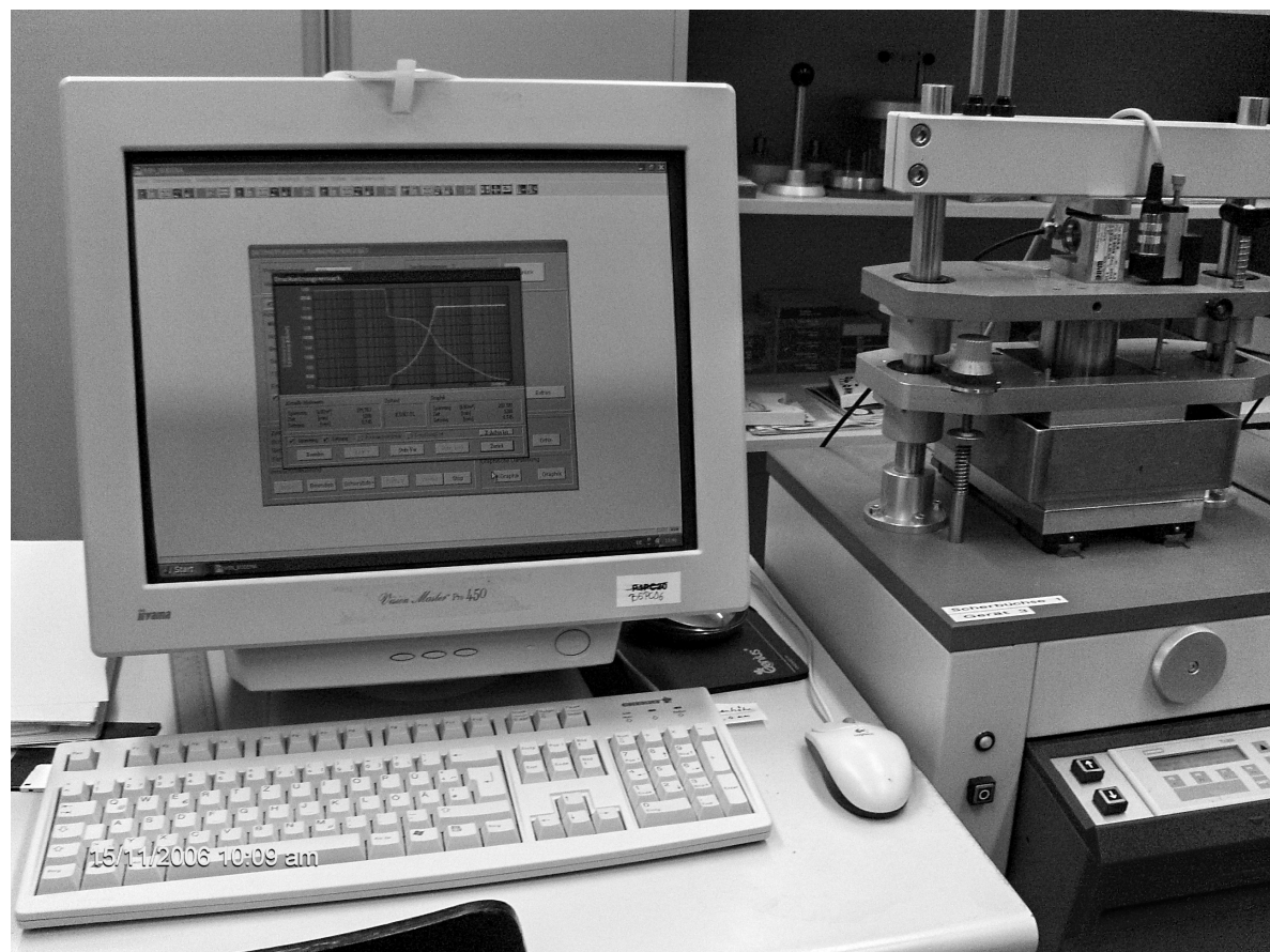
Рис. 1. Прибор для определения показателей сжимаемости и прочности фирмы Wille Geotechnik
