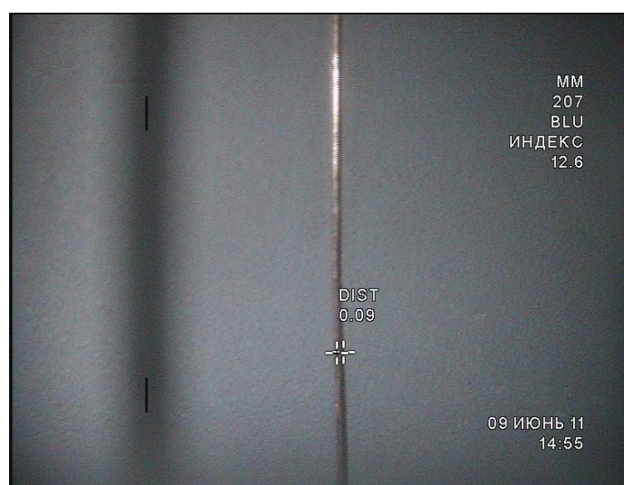
Рис. 11. Измерение толщины провода ПЭЛ диаметром 0,07 мм
