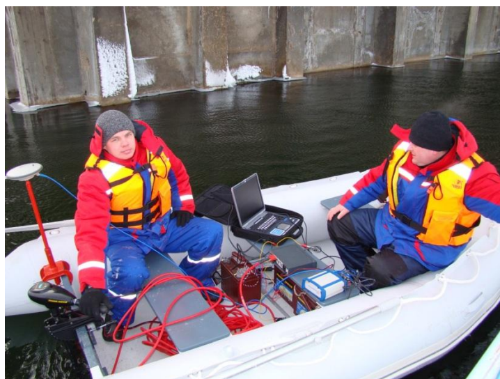
Рис. 5. Гидрографический промерный комплекс в составе параметрического эхолота и GPS-станции
