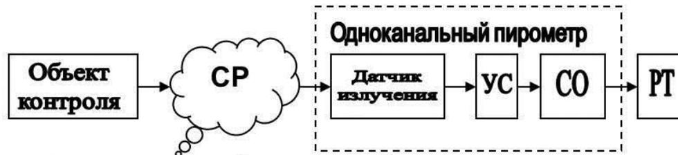
**Рис. 1.** Радиометрическая цепочка для одноканального пирометра: СР – среда распространения; УС – усилитель входного сигнала; СО – система обработки; РТ – температура в понятном для оператора коде
