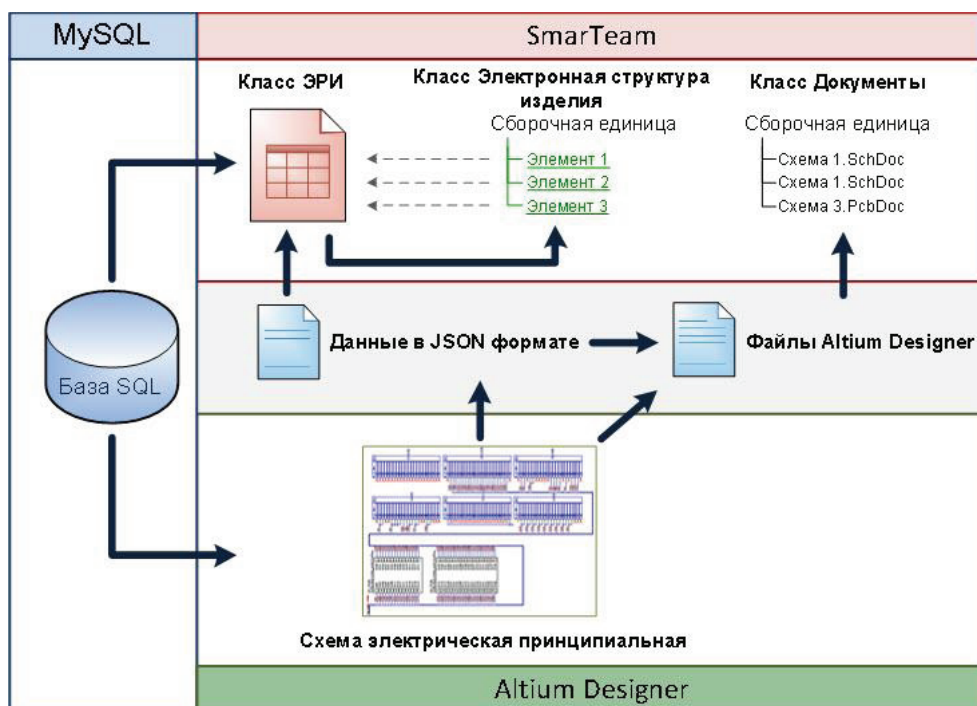
Рис. 1. Схема взаимодействия SmarTeam и Altium Designer
