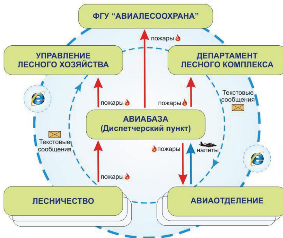
Рис. 1. Обобщенная структура системы сбора, обработки и передачи данных о лесопожарной обстановке.
