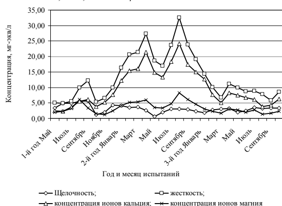
Рис. 1. Диаграмма изменения щелочности и жесткости оборотной воды, концентрации в ней ионов кальция и магния в период испытаний беспродувочного режима работы ВОЦ
