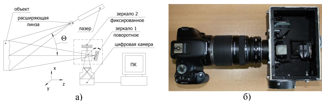
Рис. 1. Схема лабораторного стенда (а) и интерферометр с цифровой камерой (б).
