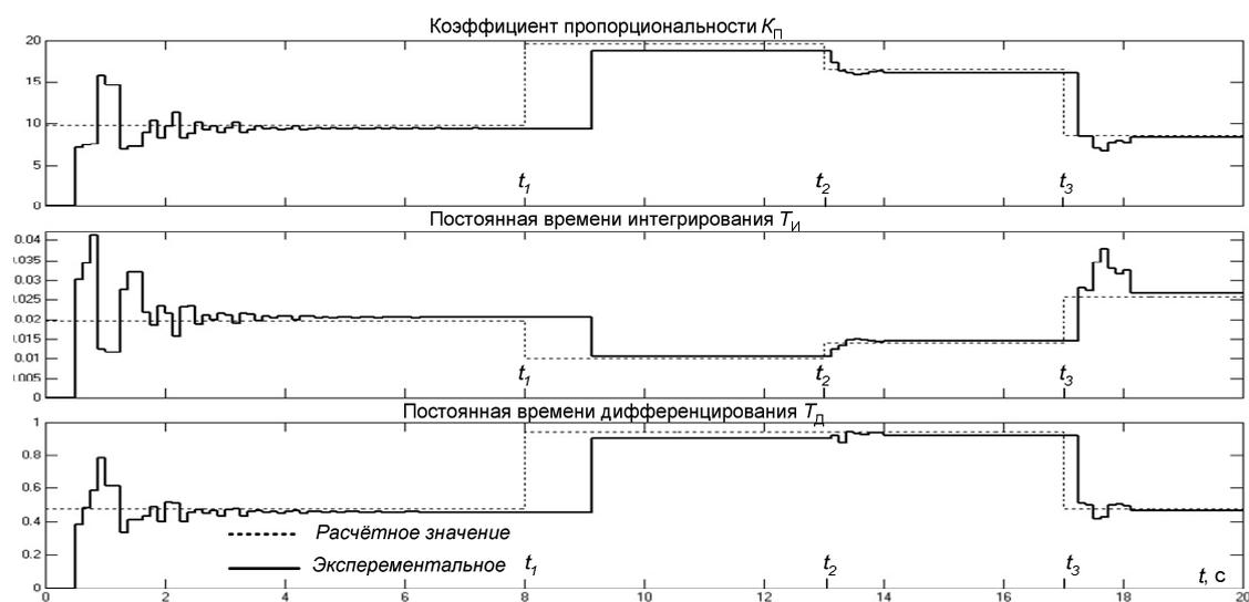
Рис. 5. Графики определения параметров ПИД-регулятора (где  $t_1, t_2, t_3$  – моменты проявления нестационарности ОУ)
