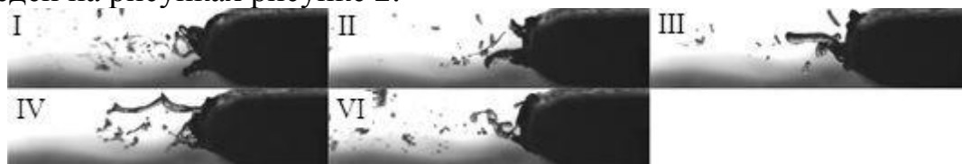
Рис. 2. Кинограмма процесса схода пленки с лопатки со скругленной кромкой. Интервал между кадрами 1,068 \cdot 10^{-4} с.
