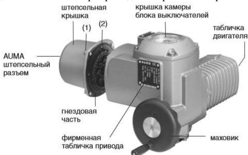
Рис. 1. Неполноповоротный электропривод с однофазным электродвигателем
