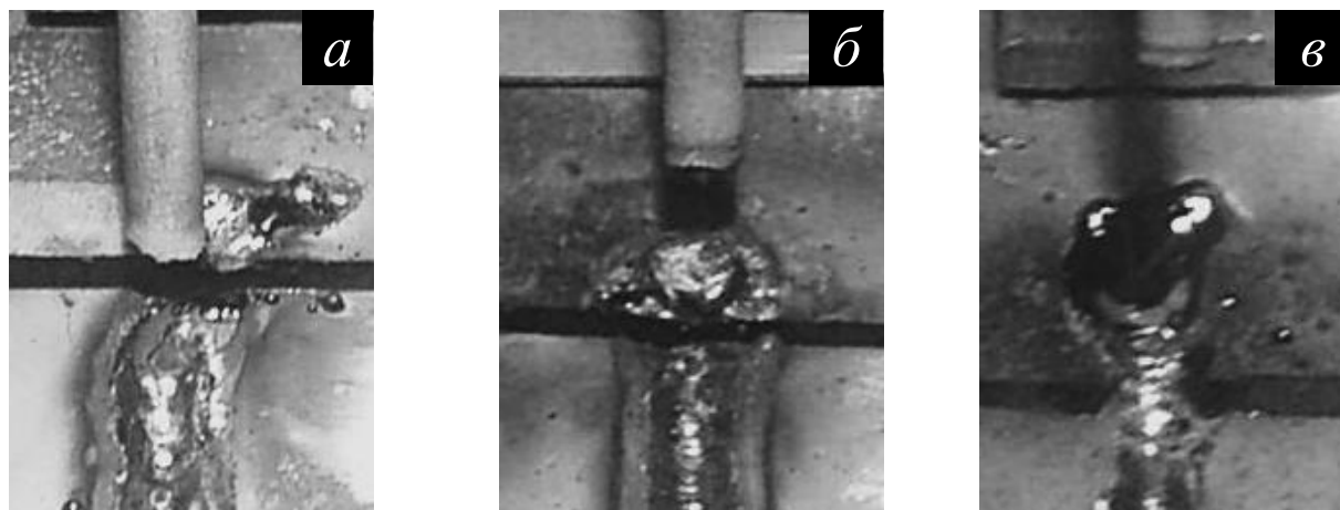
Рис. 2. Внешний вид пластин секционированного изделия и относительное расположение торца электрода после погасания: а) дуги постоянного тока обратной полярности; б, в) дуги переменного прямоугольного тока ( f = 50 и 500 Гц соответственно)
