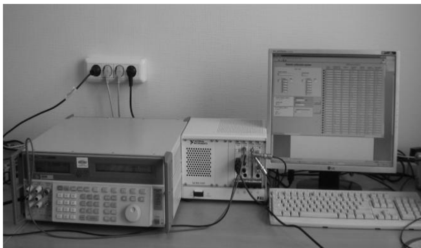
Рис. 1. Внешний вид системы дистанционной калибровки мультиметра NI PXI-4072 по переменному напряжению
