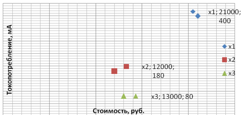
Рис. 6. Зависимость между стоимостью конечного прибора и токопотреблением
