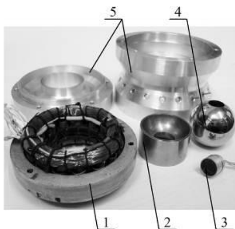
Рис. 6. Элементы макета гироскопа: 1 – статор; 2 – полусферическая чаша; 3 – датчик угла; 4 – шаровой ротор; 5 – сборный корпус
