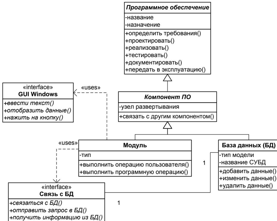
Рис. 2. Составные части проектируемого ПО и связи между ними на UML-диаграмме классов
