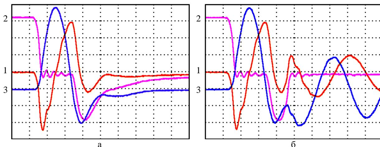
**Рис. 3.** Диаграммы тока через индуктивность  $L_{DT}$  (1) (400 А/дел), напряжение на аноде тиратрона (2) (10 кВ/дел) и напряжение на колебательном контуре (3) (10 кВ/дел). Масштаб времени 100нс/дел. а) индукционный разряд; б) – индукционный нагрев
