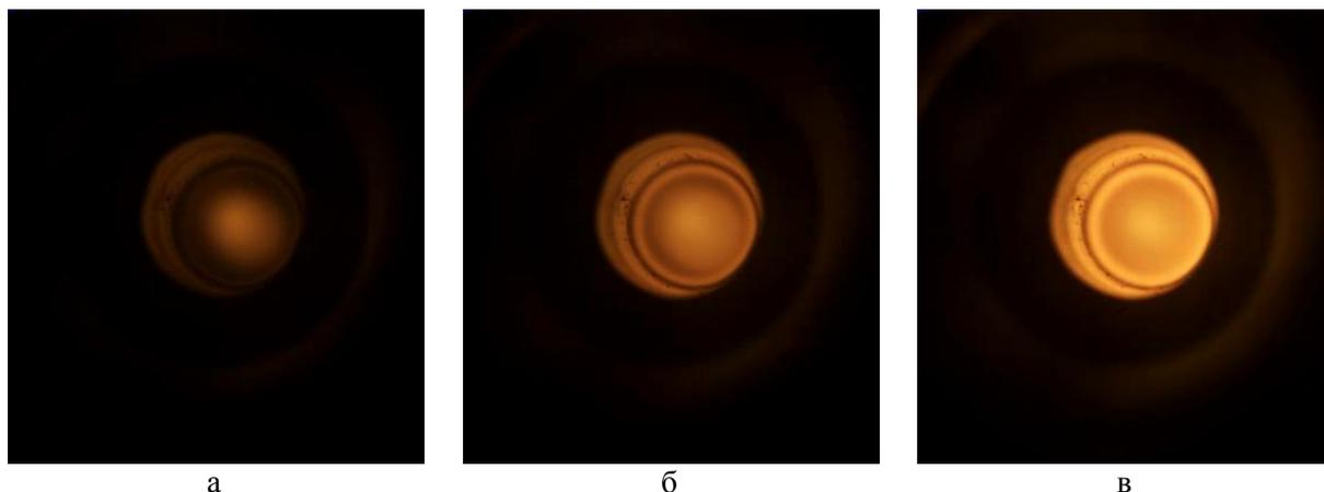
**Рис. 6.** Фотографии разрядов в ГРТ при: а) 20; б) 30; в) 40 кВ.
