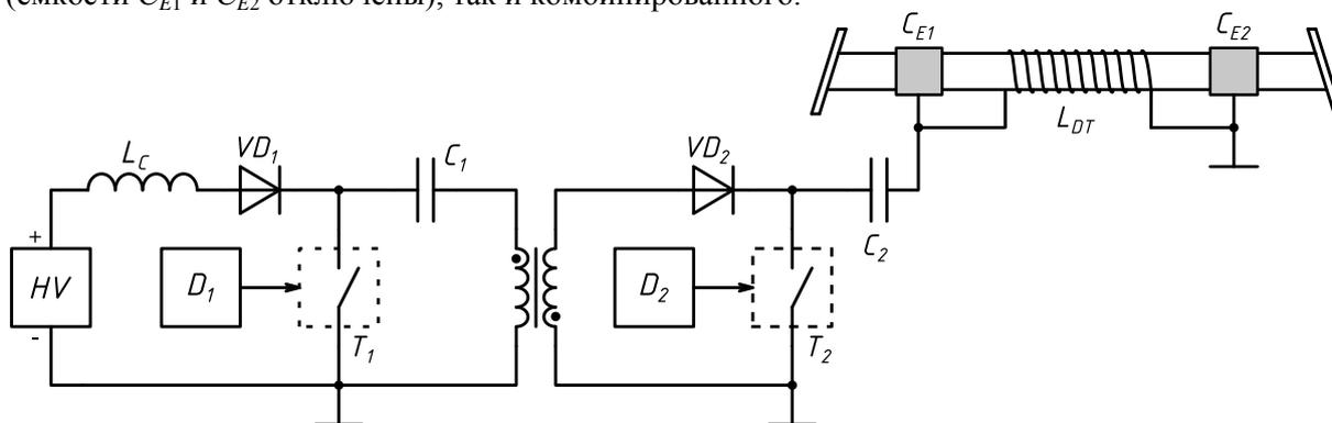
Рис. 2. Схема лабораторной установки. Вариант 2
