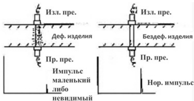
Рис. 1. Принцип действия ультразвукового контроля
