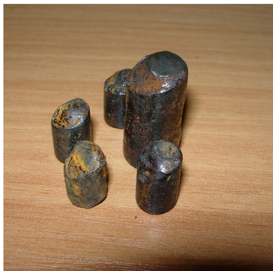
Рис. 2. Виды разрушения роликов
