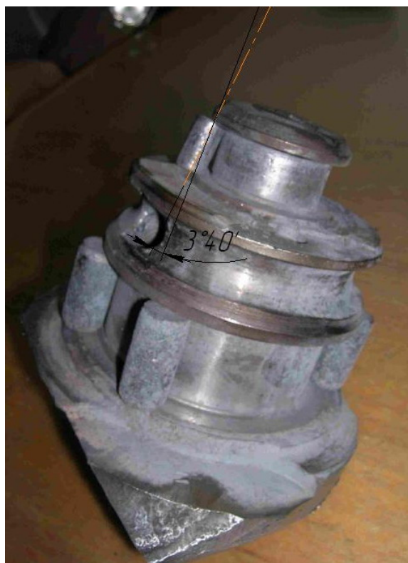
Рис. 6. Заклинившая опора бурового горнорудного долота
