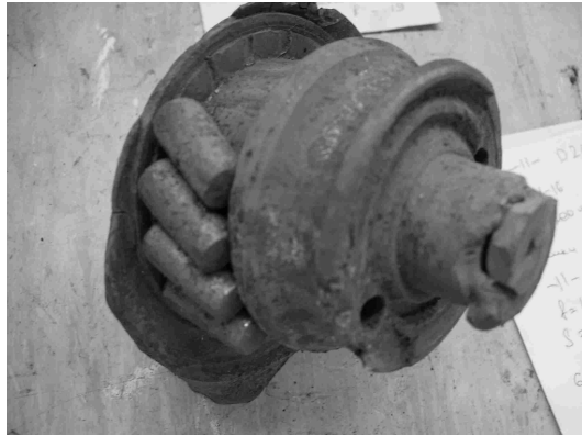
Рис. 3. Заклинивание больших роликов в бесшаровой опоре долота
