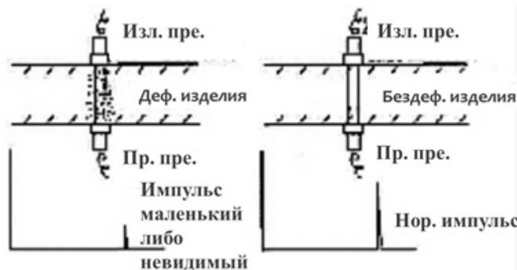
Рис. 1. Принцип действия ультразвукового контроля
