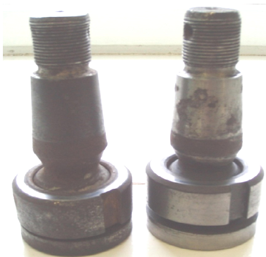
Рис. 5. На изношенном шарнире (слева) заметно сближение вкладышей. Расстояние между вкладышами у неизношенного сопряжения (справа) значительно больше
