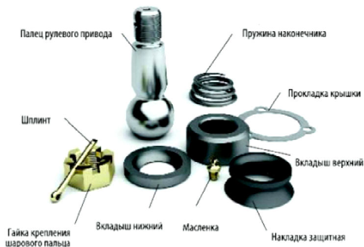
Рис. 1. Элементы рулевого шарнира автомобиля КамАЗ
