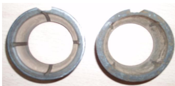
Рис. 2. Новый верхний вкладыш (слева) и изношенный (справа). На новом вкладыше отчетливо видны смазочные каналы, на изношенном они практически отсутствуют
