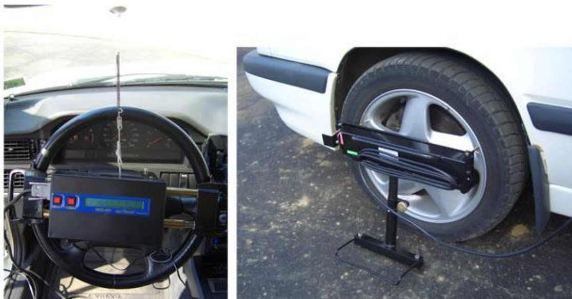
Рис. 3. Установка прибора ИСЛ-401 на автомобиль
