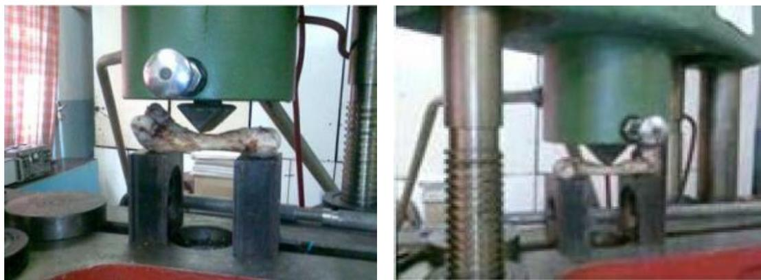
Рис. 1. Расположение испытываемой кости под прессом
