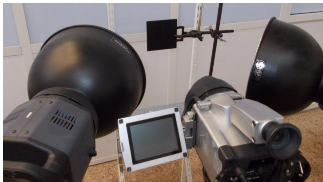
Рис. 1. Экспериментальная установка для активного теплового контроля
