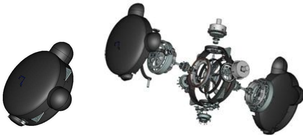
Рис. 2. Параметрическая 3D-модель гиродина
