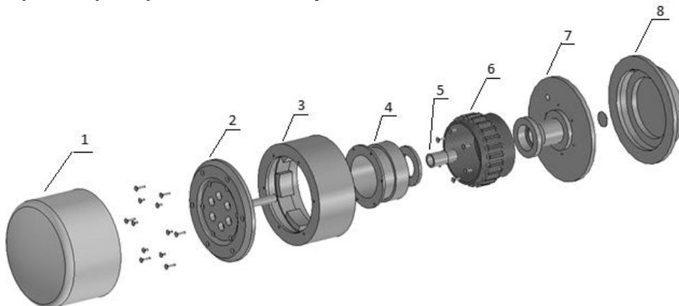
**Рис. 2.** Сборочная трехмерная модель исполнительного органа в разобранном состоянии: 1 – кожух; 2 – вал-диафрагма; 3 – обод с активными частями ротора двигателя; 4 – втулка; 5 – распорная втулка; 6 – статор двигателя; 7 – корпус; 8 – крышка
