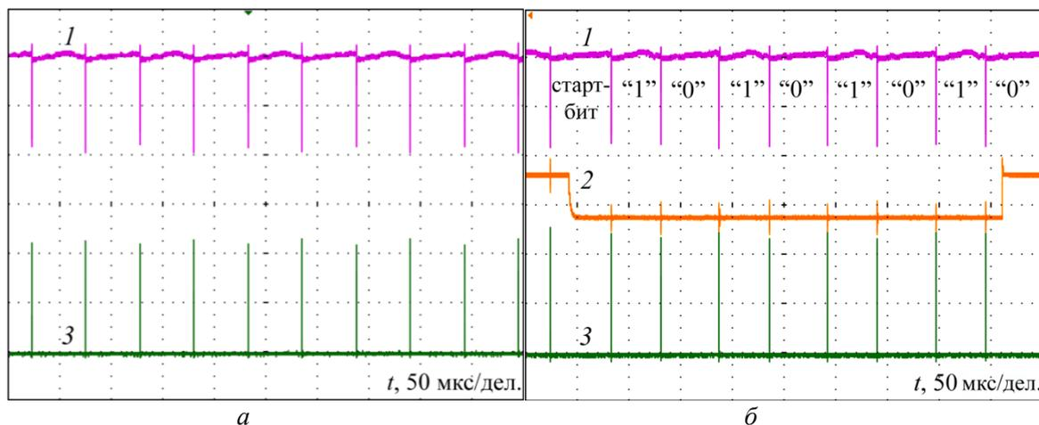
**Рис. 2.** Осциллограммы в обычном режиме (а) и в режиме передачи данных (б): 1 – напряжение на ГРТ лазера (5 кВ/дел.); 2 – импульсы синхронизации (5 В/дел.); 3 – последовательность импульсов генерации (отн. ед.)
