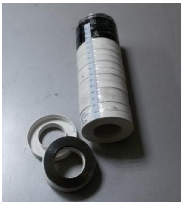
Рис. 9. Экранированная труба из лент аморфных магнитомягких сплавов
