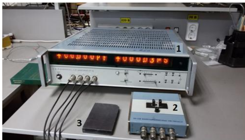
Рис. 4. Измеритель L, C, R типа E7-12 и магнит для проведения эксперимента: 1 – E7-12; 2 – адаптер; 3 – магнит
