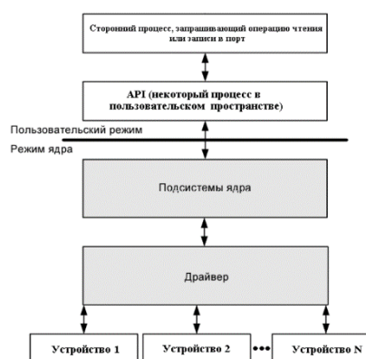
Рис. 2 – Функциональная схема информационно-логического взаимодействия между драйвером и процессом
