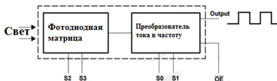
Рис. 2. Функциональная схема датчика TCS230
