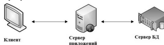
Рис. 1. Трёхуровневая архитектура системы оповещения
