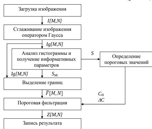
Рис. 2. Структурная схема алгоритма выделения границ
