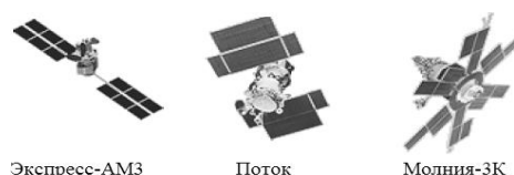
Рисунок 1 - Космические аппараты с различным исполнением крыльев солнечных батарей
