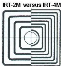
*Рисунок 2. Сравнительные размеры труб топлива ИРТ с различным топливом*
