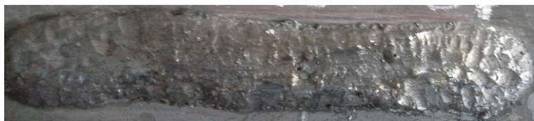
Рис. 1. Полученный наплавленный валик под флюсом 1 при оптимальном режиме
