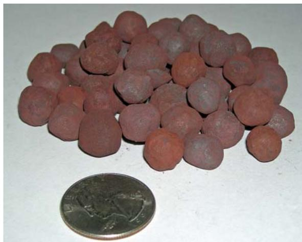
Рис. 1. Неофлюсованные железорудные окатыши с монетой номиналом 25 центов США для оценки размеров
