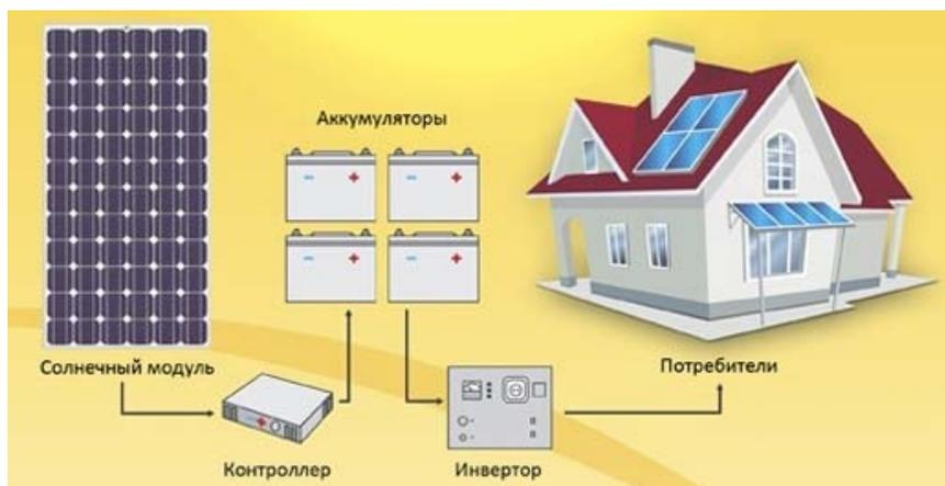
Рис. 1. Схема установки солнечной батареи
