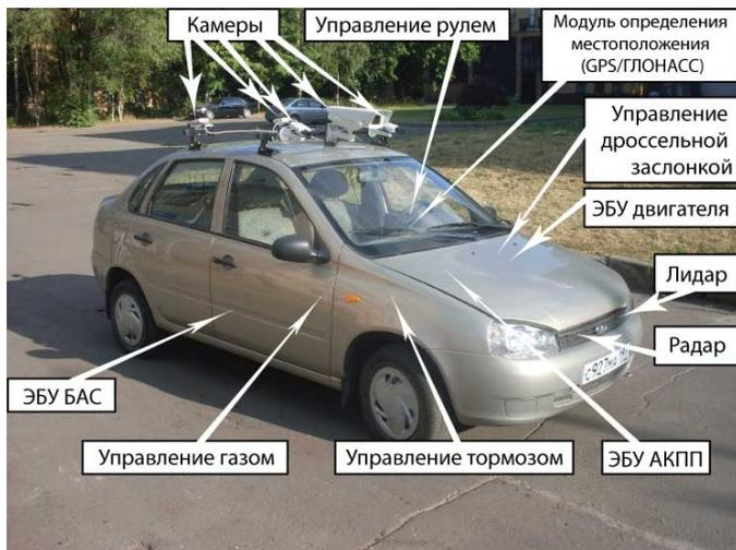
Рис. 3. Система технического «зрения» автомобиля «Лада-Калина»
