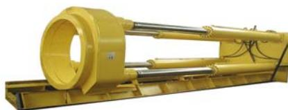
Рис. 4. Домкратная станция прессового типа
