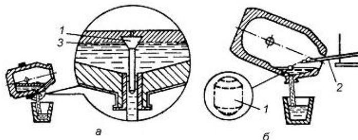
Рис. 4. Схема отделения шлака от металла при выпуске из конвертера:
