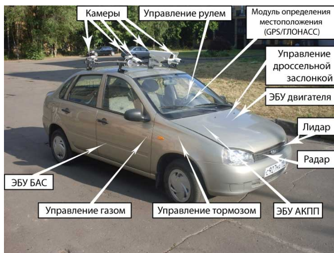
Рис. 3. Система технического «зрения» автомобиля «Лада-Калина»
