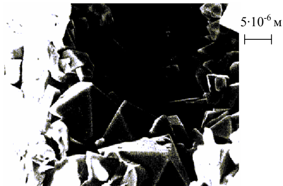
Рис. 5. Частицы оксида алюминия и железа в структуре продукта взаимодействия в системе окалина легированной стали – алюминий
