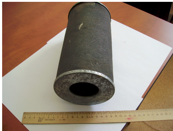
Рис. 9. Фильтрующий элемент масляного фильтра дизеля
