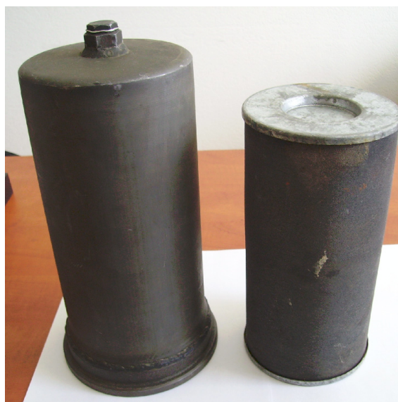
Рис. 10. Масляный фильтр в сборе (слева) и фильтрующий элемент (справа)
