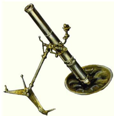
Рис. 2. 82-мм батальонный миномет образца 1941 года
