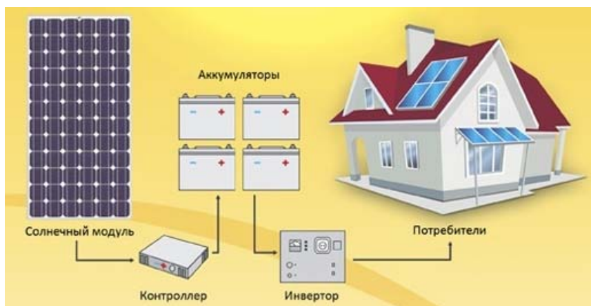
Рис. 1. Схема установки солнечной батареи
