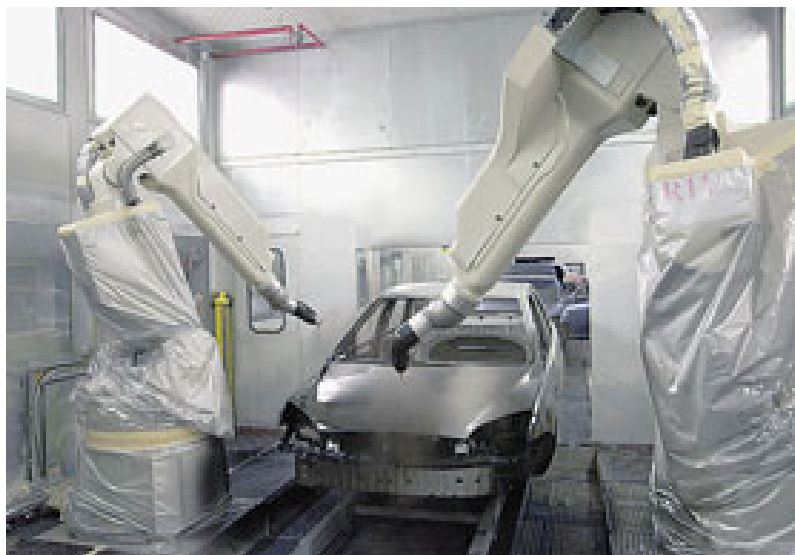
Рис. 2. Покрасочный бокс с двумя роботами на заводе «Ford-Focus»
