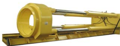
Рис. 4. Домкратная станция прессового типа
