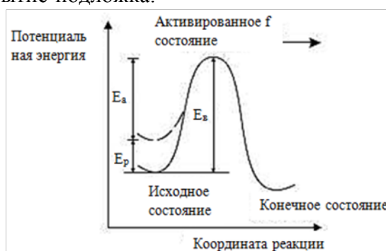
Рисунок 1 – Условная схема изменения потенциальной энергии системы атомов материалов частицы и основы в зоне контакта [1]
