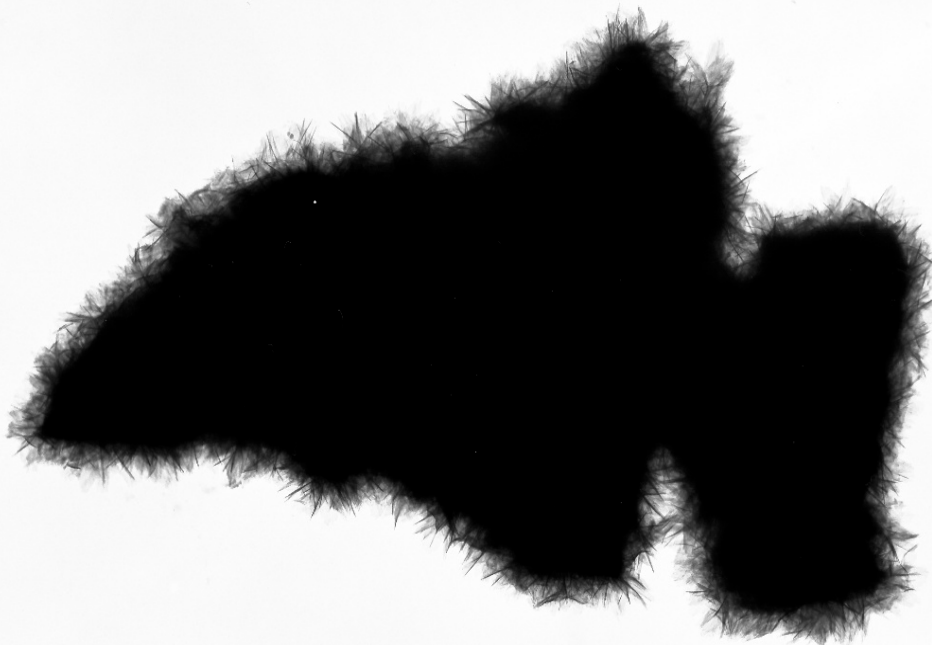
Рисунок 1 – Электронная микрофотография образца сорбционного материала на основе минерала сланец с нановолокнами оксигидроксида алюминия (увеличение в 10 тысяч раз)
